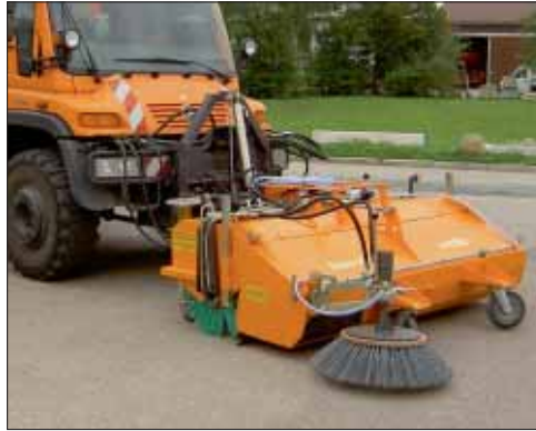
FKM mit Schmutzsammelbehälter am Unimog
