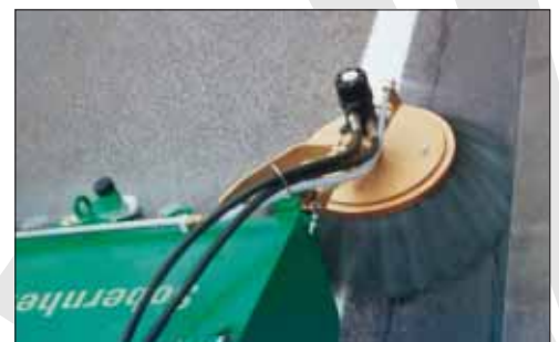
Seitenbesen mit Parallelogrammaufhängung
