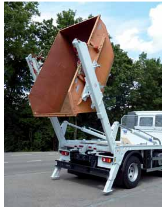
Container können mit teleskopierten Hubarmen hoch ausgeleert und in andere Container umgeleert werden.
