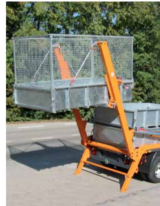
Bis zu drei Flachbehälter oder Container können gestapelt und somit mehrerer Baustellen mit einer Fahrt ver- oder entsorgt werden.
