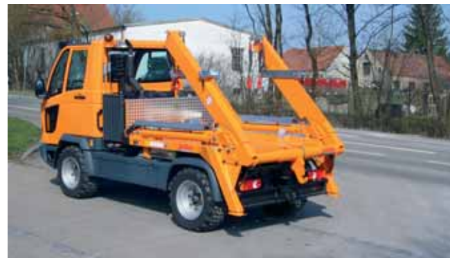
Der CombiCon auf Schmalspurfahrzeugen transportiert und kippt auch "Multicar"- und andere Standardbehälter.
