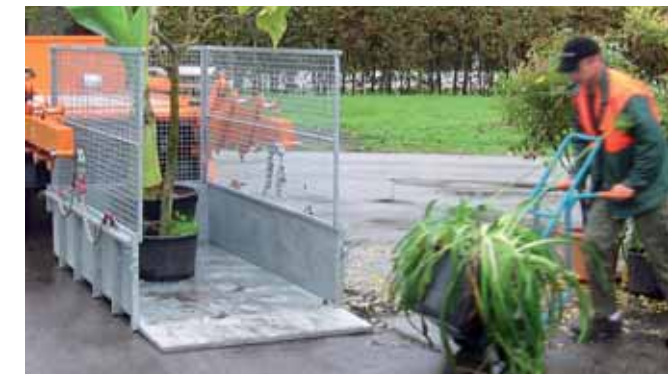
Pflanzen, Sträucher oder beliebige andere Transportgüter werden ebenerdig geladen und in der Waagrechten aufgenommen.
