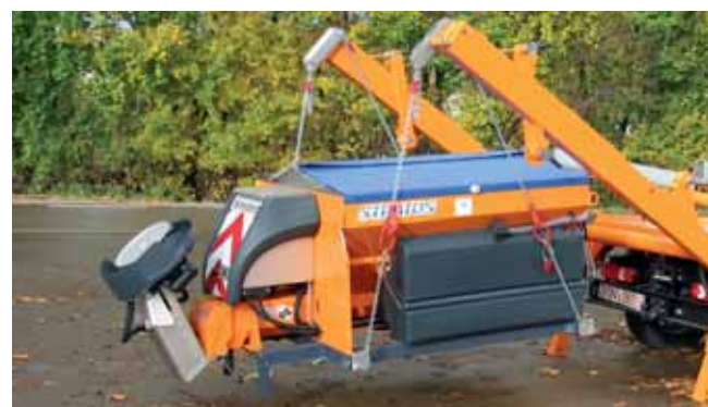
Salzstreuer, Teerkocher und andere Arbeitsgeräte werden innerhalb weniger Minuten gewechselt und sind sofort einsatzbereit.
