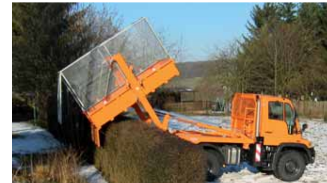
Sand, Kies, Humus, Mulch, Garten- und Pflanzenabfälle können über Hindernisse hydraulisch hoch ausgekippt werden.
