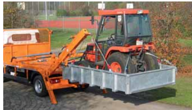
Verladen und Transport von Maschinen und schweren Gütern ist mit dem Flachcontainer einfach und sicher.
