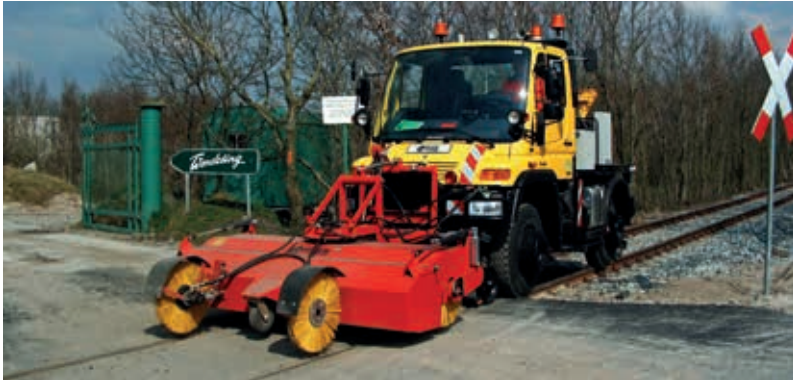
Zur Reinigung von Schienenrillen können an der Schmutzsammelwanne zwei Besen senkrecht montiert werden.
