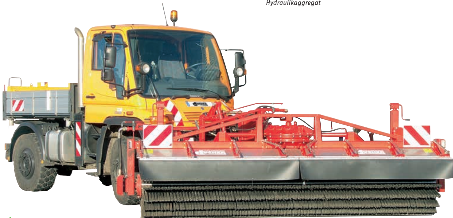
GFK am Schlepper mit im Heckanbau montiertem Hydraulikaggregat
