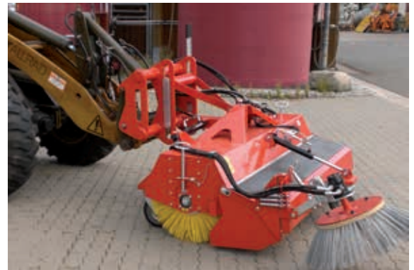
HDK am Radlader mit Höhenausgleich
