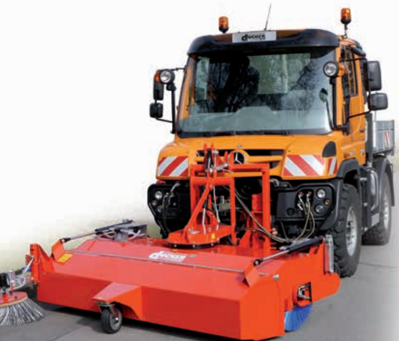
hydraulische Seitenverstellung um 0,60 m
