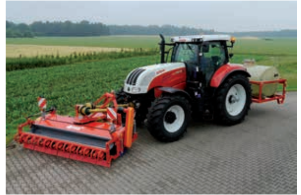
SFK mit Schmutzaufkrazleiste und Wasserhochdruckanlage in Heckanbau
