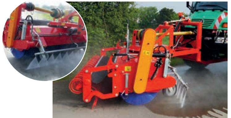
Sonderausführung der SFK 2200 mit Aufkrazleiste, Wasserhochdruckanlage und Schwemmbalken
