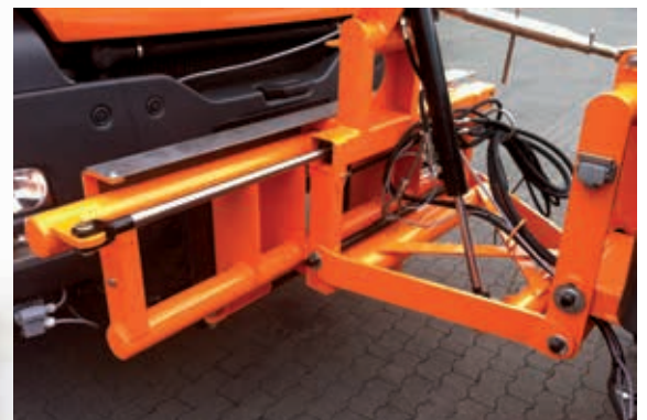
hydraulische Seitenverstellung um 0,60 m
