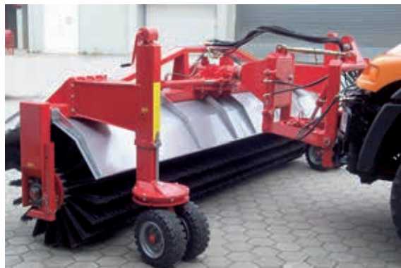
Bodenanpassung über höhenverstellbare Räder
