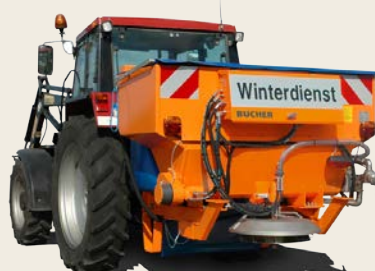
Gmeiner Tracon Plus: Lieferbar in Behältergrößen von 0,8 m³ und 1,2 m³ mit und ohne Feuchtsalzausstattung.
